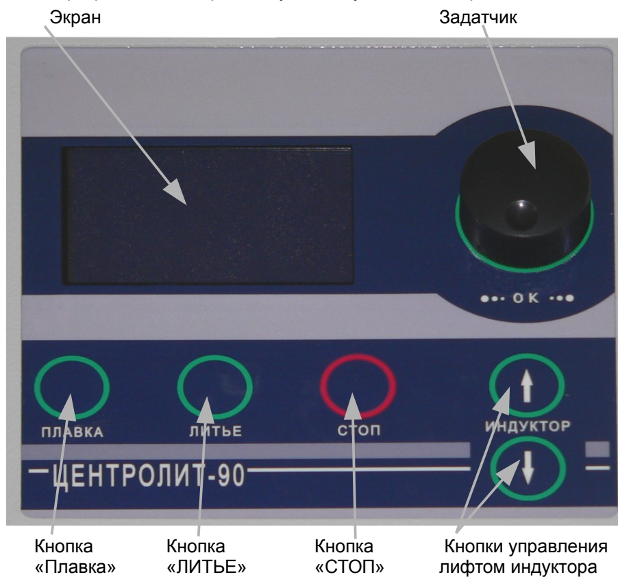
Рисунок 4. Лицевая панель ЦЕНТРОЛИТ-90
